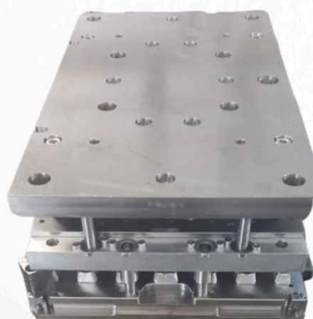
Cassettes de dégrappage des cartes électroniques
