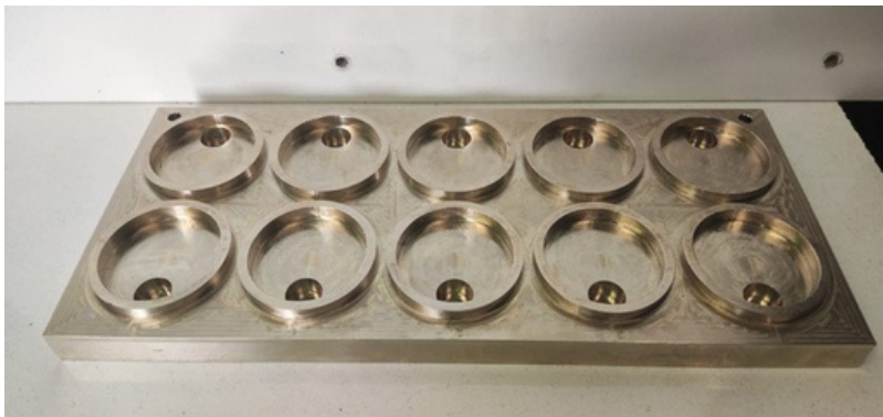
Plaque en Bronze pour la soudure de film aluminium sur une boîte
