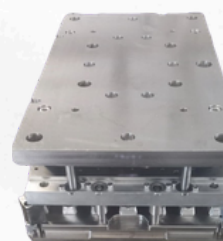
Cassette de dégrappage des cartes électroniques
