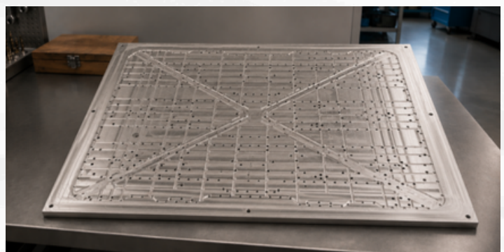
Moule de thermoformage pour supports électroniques
