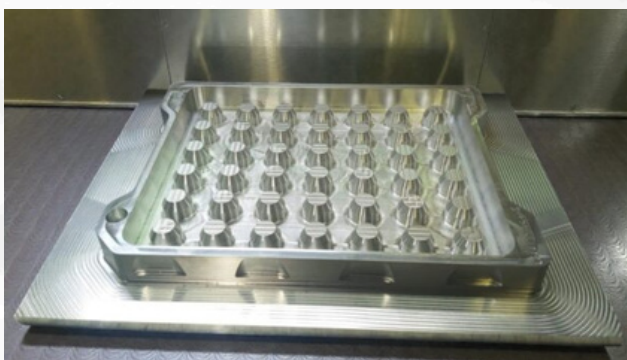
Moule de thermoformage pour supports électroniques
