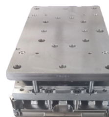
Cassette de dégrappage des cartes électroniques
